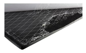
Wird die Trägerfolie nun unvorsichtig oder zu schnell abgezogen, kann es passieren, dass die Klebstoffschicht stellenweise an der Trägerfolie haften bleibt und vom Schaumstoff abgezogen wird.
