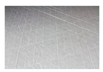
Bedingt durch den Herstellungsprozess kann die Trägerfolie mit der Klebstoffschicht über die Ränder des Schaumstoffs überstehen. Außerdem kann es durch Transport oder Lagerung zur Faltenbildung in der Trägerfolie kommen.
