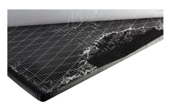
Si on retire le film support trop vite ou trop brusquement, il peut arriver qu'une partie de la couche adhésive adhère par endroits au film support au lieu de rester sur la mousse.
