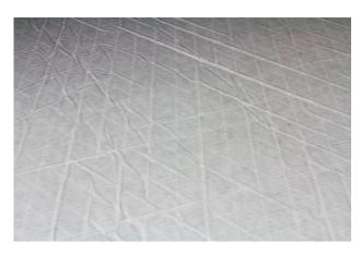
Debido al proceso de fabricación, es posible que la lámina de soporte con adhesivo sobresalga de los bordes de la espuma. Además, debido al transporte o almacenamiento, es posible que se formen pliegues en la lámina.
