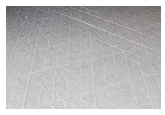
En raison du processus de fabrication, il peut arriver que le film support et sa couche de colle dépassent légèrement des bords de la mousse. Des plis occasionnés par le transport ou le stockage peuvent également apparaître sur le film support.
