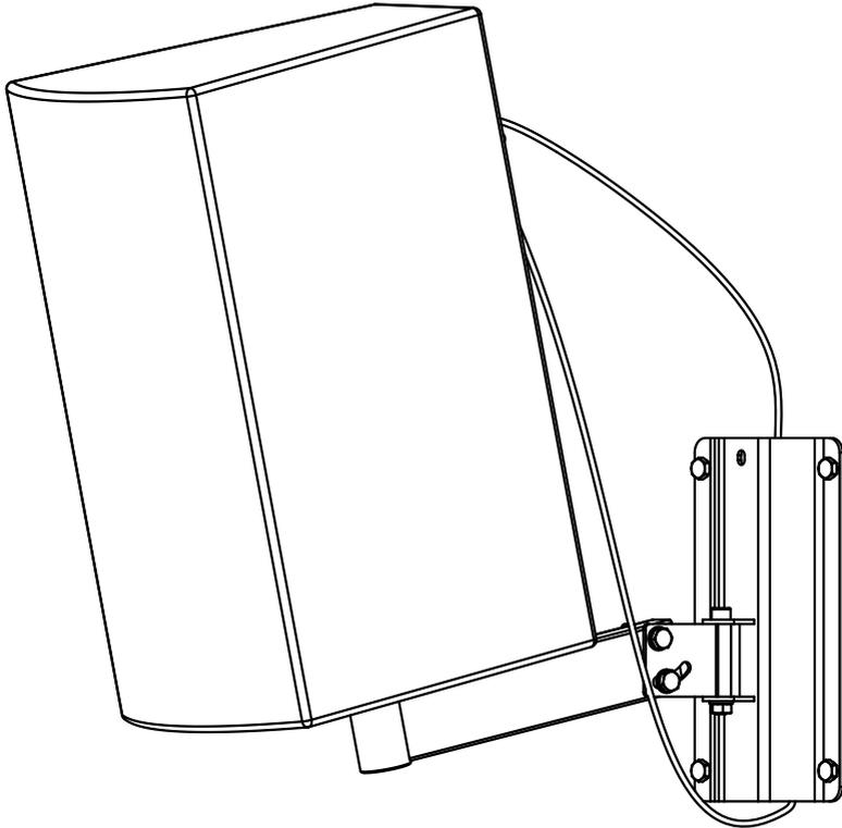
Aufgrund der gesetzlichen Bestimmungen (BGV-C1 §7 „Schutz gegen herabfallende Gegenstände“) müssen Lautsprecher zusätzlich zur Anbringung am Wandhalter mit einer Einrichtung wie z.B. einem Stahlseil (z.B. Adam Hall S53102B oder S53100) gegen Herabfallen gesichert werden.
