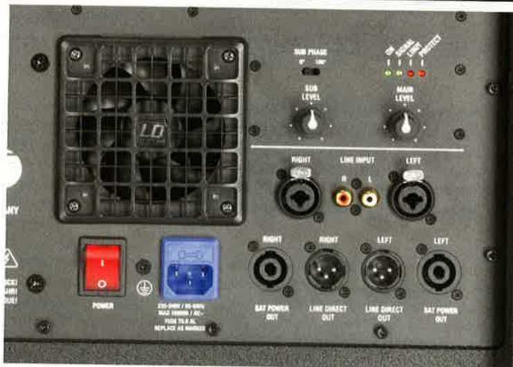
Anschluss- und Bedienfeld mit Blick auf Lüfter und internen DSP
